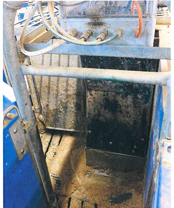
Abbildung 3. Futterreste vor dem Futtertrog in der Abrufstation. Am oberen Bildrand das Kommunikationsrelais. Im unteren Bilddrittel der futterschmierte Stationsboden.
